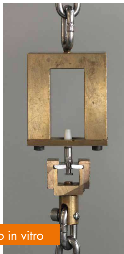
Imagen*: Montaje experimental para la comprobación de la resistencia a la tracción (velocidad de barrido: 2 mm/min)
