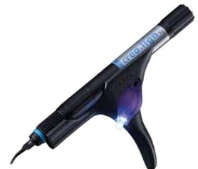
Der Einhandgriff ist speziell für die crea.lign Gel Spritzen konzipiert und erleichtert in Verbindung mit der Applikationskanüle dem Anwender das exakte Dosieren mit einer Hand. Durch den Einhandgriff liegt die Spritze sauber in der Handfläche und das flüssige Gel kann durch Drehen der geriffelten Drehvorrichtung mit Daumen oder Zeigefinger derselben Hand dosiert werden. Die andere Hand bleibt frei für andere Arbeiten, z.B. das Halten des zu bearbeitenden Objekts.
