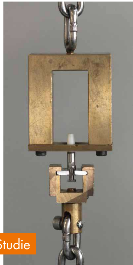
Bild*: Versuchsaufbau – Zugfestigkeitsprüfung (Geschwindigkeit des Kreuzkopfes von 2 mm/min)
