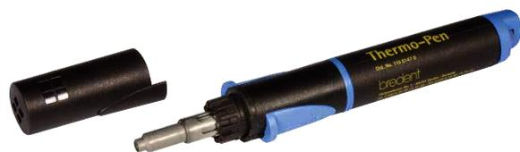
L'apparecchio Thermo-Pen è un soffiatore ad aria calda con sistema a piezo-elettrico, senza fiamma. Pertanto le faccette estetiche possono essere scaldate, senza il pericolo di essere bruciate. La temperatura necessaria per modellare le faccette è di ca. 250° C. Grazie alla dilatazione p.es. possono essere coperte in modo ottimale le corone telescopiche.
