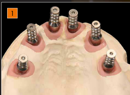
1 Réalisation du modèle avec fausse gencive (masque Multisil souple) et du plâtre extra-dur de la classe 4 (Exakto-Rock S).
