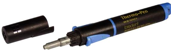
Der Thermo-Pen ist ein Heißluftgebläse mit Piezo-Technik ohne offene Flamme. Somit können die Verblendschalen erhitzt werden, ohne Gefahr zu laufen, dass diese verbrennen. Die notwendige Temperatur um die Verblendschalen zu verformen liegt bei ca. 250° C. Durch das Aufdehnen können z. B. Teleskopkronen besser abgedeckt werden.
