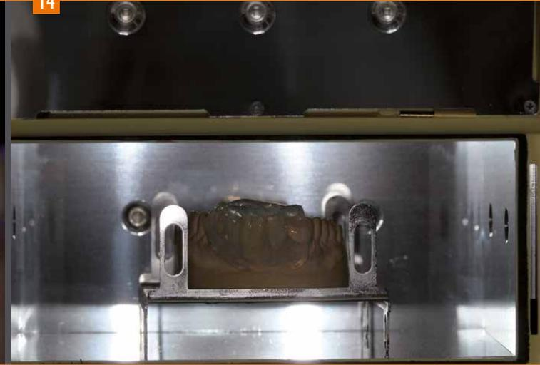
Fotopolimerización final de la reconstrucción en el equipo de fotopolimerización.
