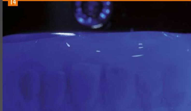
Fotopolimerización final durante 360 seg. en el equipo bre.lux Power Unit.
